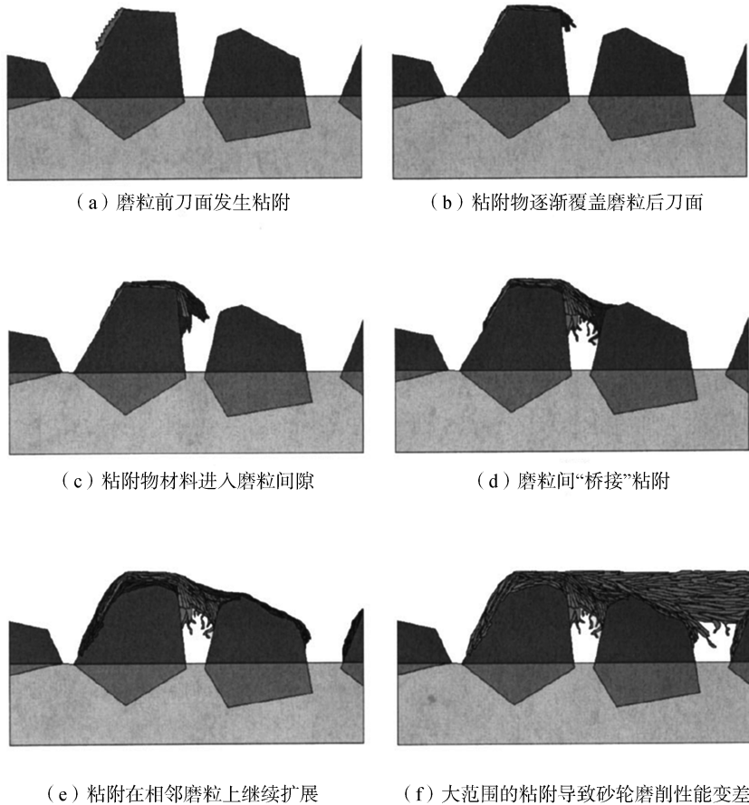
图5 砂轮粘附机理示意图
